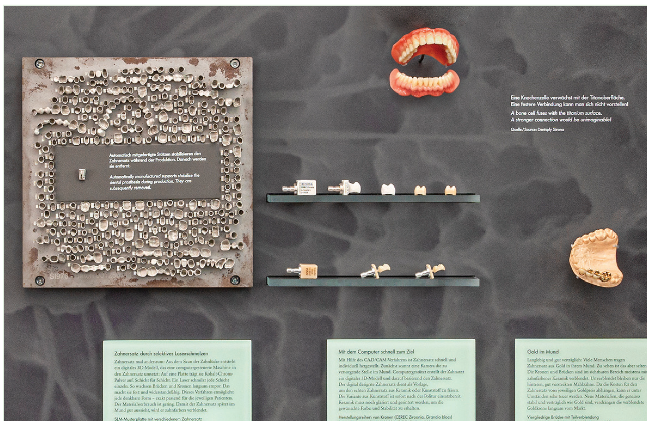
Anhand der nanokeramischen Hybrid CAD/CAM-Blöcke Grandio blocs wird das dentale Fräsverfahren erläutert. (© Deutsches Museum München)
