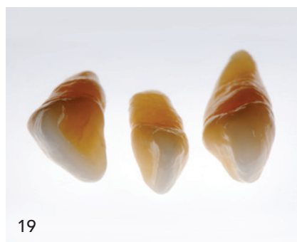
Abb. 18–20: Mittels Lithoz LCM-Verfahren (LCM = Lithography-based Ceramic Manufacturing) gefertigte, dreidimensional geschichtete Zähne aus Lithiumdisilikat.
