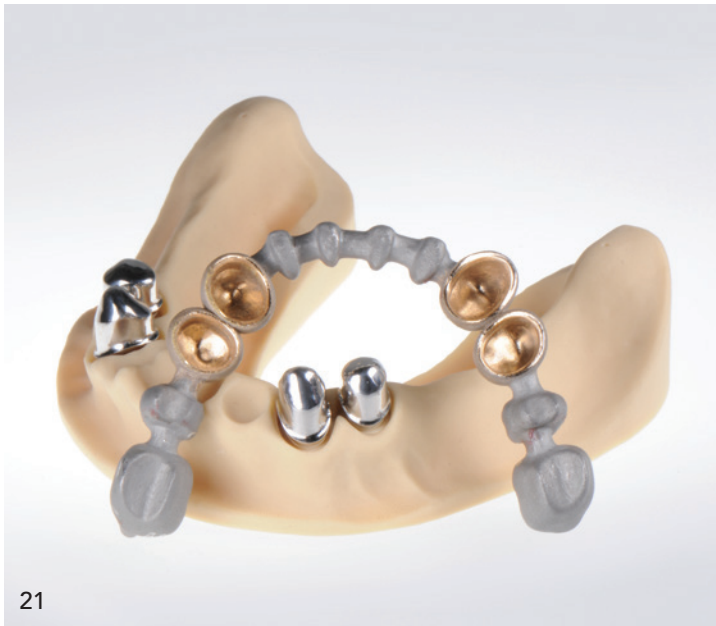
Abb. 20 und 22: Demonstrator eines Metallgerüsts für eine Teleskopversorgung im Unterkiefer aus zwei verschiedenen Metallen (hochgoldhaltige Legierung, CoCrMo-Legierung), zusammen hergestellt in einem Bauprozess mittels Metall-Multimaterial-3D-Druck.
