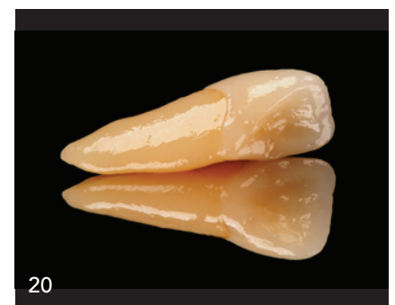
Abb. 18–20: Mittels Lithoz LCM-Verfahren (LCM = Lithography-based Ceramic Manufacturing) gefertigte, dreidimensional geschichtete Zähne aus Lithiumdisilikat.
