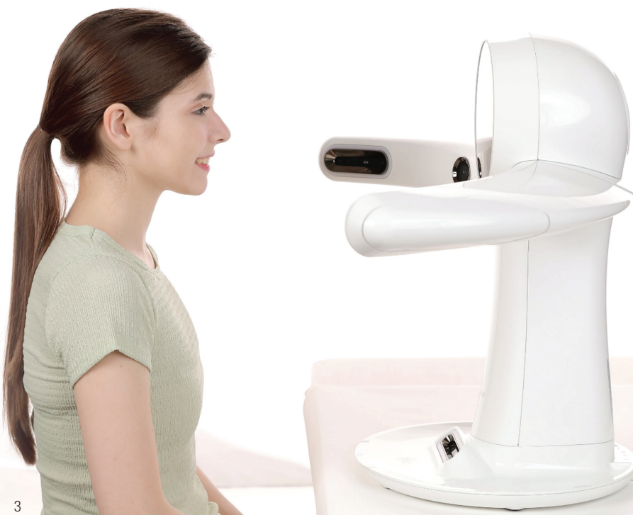
Abb. 3: Mit dem One-Shot-Scanning RAYFace können Gesichtsdaten mithilfe der Serienbildfunktion in 0,5 Sekunden schnell und einfach erfasst werden. Abb. 4: Evaluation natürlicher Asymmetrien, die beim Anfertigen des Zahnersatzes berücksichtigt werden.
