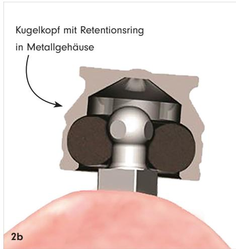
**Abb. 2a und b:** Das „Softloading“-Prinzip von MDI: Zu keinem Zeitpunkt haben die Metallgehäuse Kontakt zum Kugelkopf, ein auswechselbarer Gummiretentionsring verhindert den Verschleiß des Kugelkopfs.
