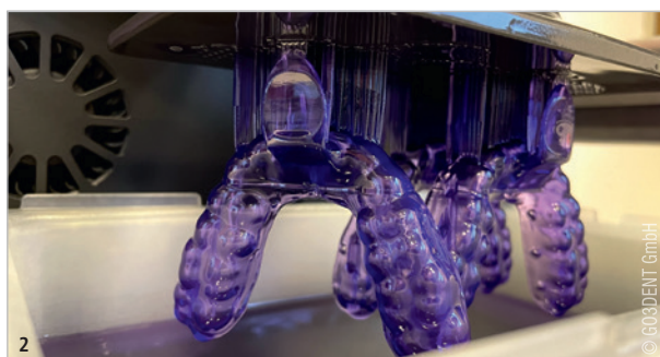
Abb. 1: Adjustierte Schienen gedruckt mit einem DLP 3D-Drucker. – Abb. 2: Individueller Löffel gedruckt mit einem DLP 3D-Drucker.
