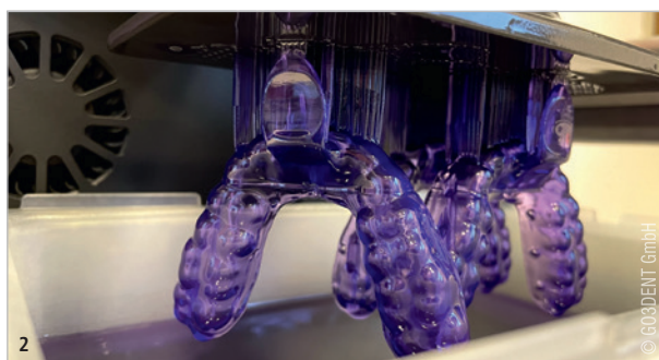
Abb. 1: Adjustierte Schienen gedruckt mit einem DLP 3D-Drucker. – Abb. 2: Individueller Löffel gedruckt mit ein DLP 3D-Drucker.
