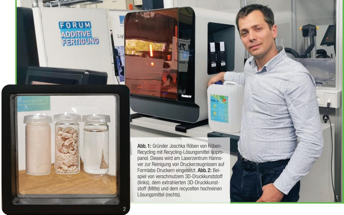
**Abb. 1:** Gründer Joschka Röben von Röben-Recycling mit Recycling-Lösungsmittel Isopropanol. Dieses wird am Laserzentrum Hannover zur Reinigung von Druckerzeugnissen auf Formlabs-Druckern eingesetzt. **Abb. 2:** Beispiel von verschmutztem 3D-Druckkunststoff (links), dem extrahierten 3D-Druckkunststoff (Mitte) und dem recycelten hochreinen Lösungsmittel (rechts).
