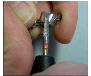
Voraussetzungen für eine problemlose Verblendung mit allen hochschmelzenden Verblendkeramiken ist die richtige Oberflächenbearbeitung mit rotierenden Instrumenten.
