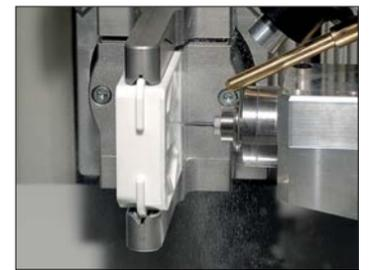
... erlauben eine hochpräzise Bearbeitung von Zirkonoxid.
