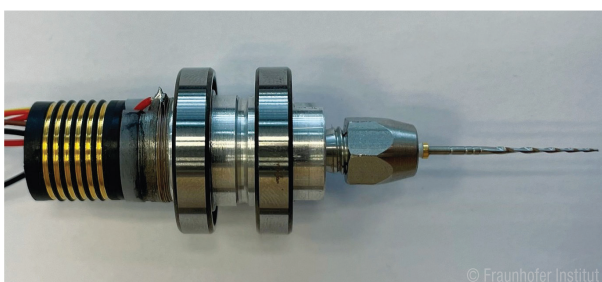
Abb. 1: Zahnfeile mit integriertem piezokeramischen Stapelaktor.
