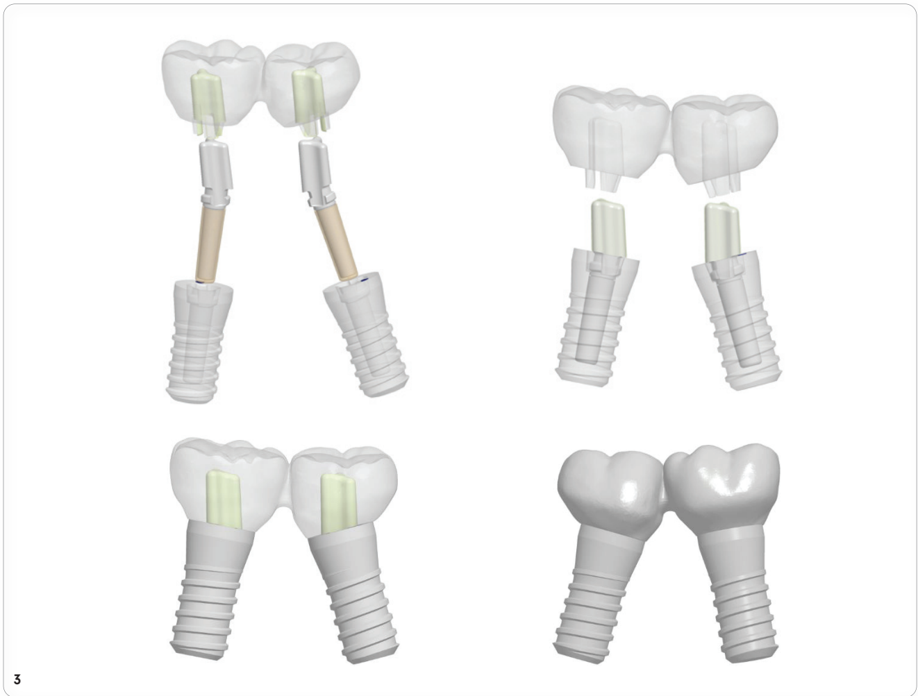
Abb. 2: Verkoppelung zwischen Implantatkörper und Abutment durch eine Renk-Verbindung mit Rotation des Abutments bei Rechtsdrehung um 60 Grad. Beim Eindrehen senkt sich das Abutment mit 5 Grad in die Endposition. Die Rotationssicherung erfolgt dann durch das Aufsetzen der Zahnkrone. – Abb. 3: Implantat, individuelle Abutments, Brücke auf nicht achsparallelen Implantaten.
