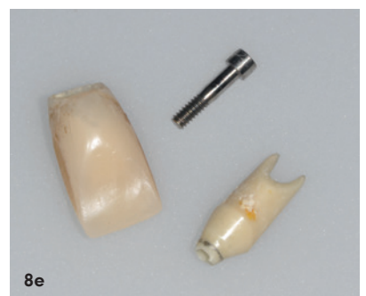
Abb. 7: Implantattyp mit konischer Innenverbindung, bei dem die Abutmentposition stark vom verwendeten Befestigungsdrehmoment abhängt und wo es hier zum Aussprengen der Implantatschulter gekommen ist. – Abb. 8: Titanimplantat mit aus Zirkondioxidkeramik bestehendem Abutment (a), welches in diesem Fall vollständig frakturierte (b), wohingegen auch Teilfrakturen vorkommen können (c). Problematisch sind hier Bruchstücke, welche die Innenverbindung des zu re-restaurierenden Implantates kontaminieren (d, e).
