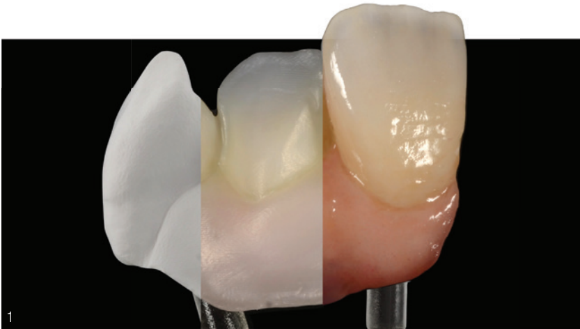
Abb. 1: Links: weißes Zirkonoxid, ungesintert; Mitte: mit Initial Zirconia Coloring Liquids, gesintert; Rechts: fertiggestellt mit dem Initial IQ ONE SQIN Konzept. © Mit freundlicher Genehmigung von ZTM Stefan Roozen.
