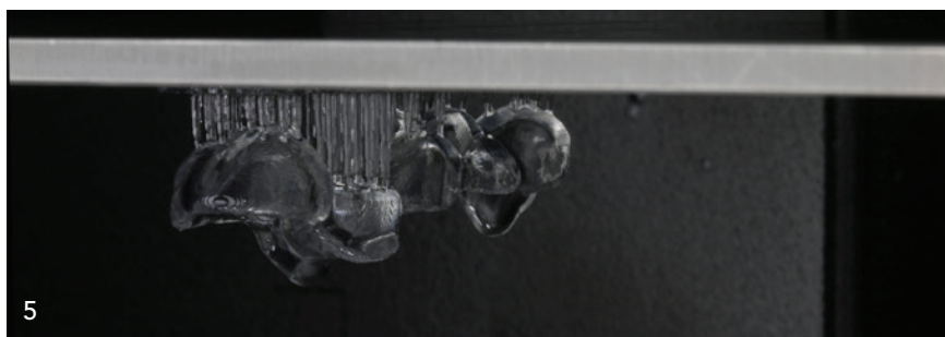
Abb. 5: Bohrschablone mit Stützstrukturen im 3D-Drucker.
