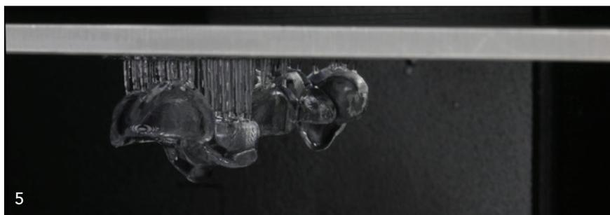
Abb. 5: Bohrschablone mit Stützstrukturen im 3D-Drucker.
