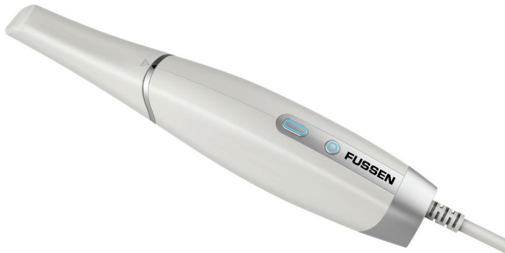
Mit seiner beeindruckenden High-Definition 3D-Videoaufnahmetechnologie und einer Kantengenauigkeit von unter 10 µm liefert der FUSSEN Intraoralscanner detailreiche und präzise Bilder, die eine unübertroffene diagnostische Klarheit bieten.
