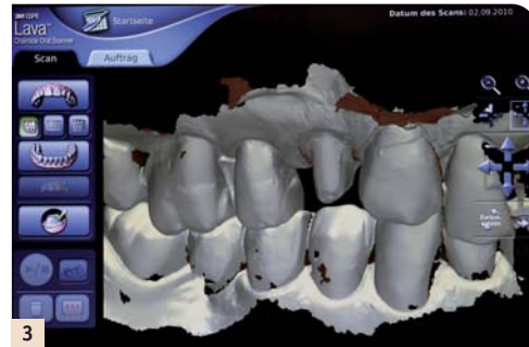
Abb. 1: Kurzweiliges Blaulicht mit Streifenlichtprojektion, System CEREC AC. (Foto: Ender) – Abb. 2: Einzelaufnahmen werden zu einem Modell zusammengefügt. (Foto: Sirona) – Abb. 3: Optoelektronischer Intraoral-Scan des C.O.S. Lava-Systems. Kronenstumpf und Präp-Grenze sind exakt dargestellt. Der Datensatz erlaubt neben der Gerüstfertigung auch die Produktion eines stereolithografisch hergestellten Kunststoffmodells (SLA) mit Gegenbiss. (Bild: Wöstmann)
