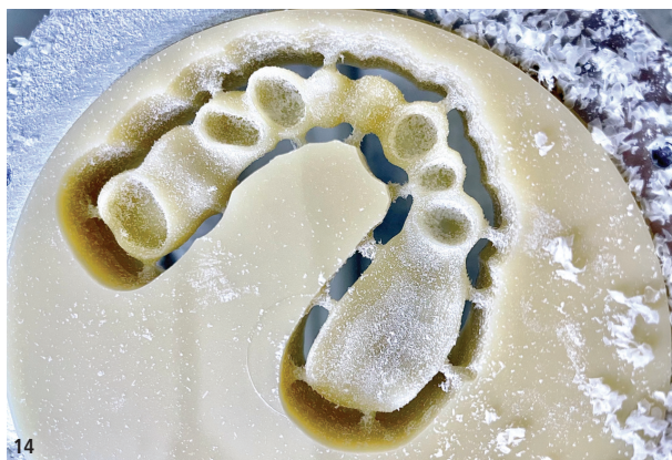
Abb. 13: Die einzelnen, taktil gescannten Stümpfe. – Abb. 14: Gefräster Prototyp auf Basis des Vorscans zur Kieferrelationsbestimmung. – Abb. 15: Fertige Sekundär- und Gerüstkonstruktion als Einstückfräsung.
