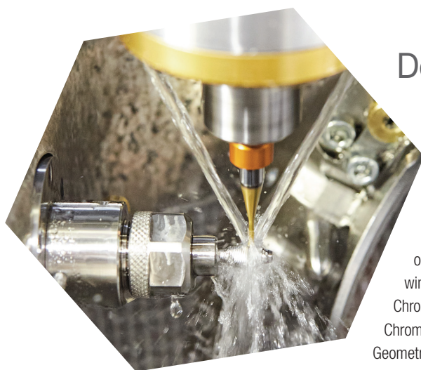
Der FRANKEN-CIMT Fräser bei der Abutmentbearbeitung mit der 6. Achse der CIMT Pi5 Turn.
