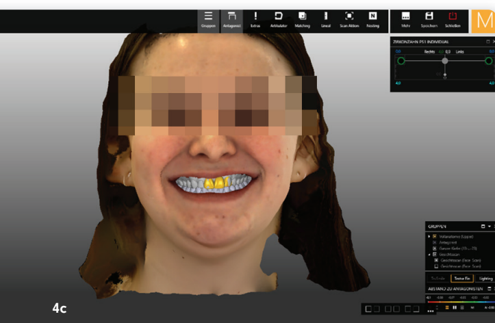
Abb. 4a–c: Virtuelle Planung mittels Gesichtsscans und intraoraler Scandaten: Facescan des Patienten (a), Zusammenführen der digitalen Patientendaten (b), Visualisierung der zahn-technischen Konstruktion (c).
