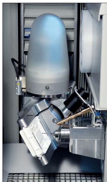
Die Materialbearbeitung erfolgt hochpräzise mit drei oder fünf Achsen.
