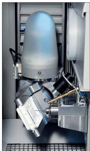
Die Materialbearbeitung erfolgt hochpräzise mit drei oder fünf Achsen.
