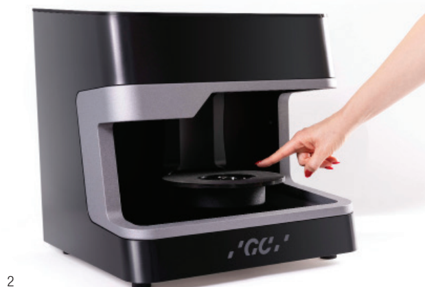
Abb. 1: Modellscanner bleiben auch im Zeitalter des Intraoralscannern aktuell – und liefern oft die zahnmedizinisch nützlicheren Daten. – Abb. 2: Die heute mögliche Steuerung des Geräts mittels Gesten ermöglicht eine intuitive Bedienung (z.B. Aadv Lab Scanner 3, GC).
