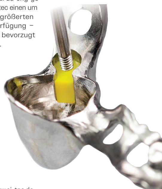
Einfaches Überprüfen des Aufnahmekanals mit dem Platzhalter
