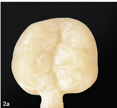
Abb. 2: Kronen nach dem Fräsen (2a) bzw. Drucken (2b). Beim Fräsen bleibt ein Haltesteg stehen, der hier seitlich am Werkstück platziert ist und sich leicht von Hand entfernen lässt. Die Stützstruktur des 3D-Drucks bestand aus mehreren dünneren Stegen, die sich auch direkt auf der Kaufläche befanden. Bei ihrer Entfernung können die feinen Details einer modellierten Kaufläche wieder verloren gehen. Reste des Druckharzes sind noch als weiße Schicht erkennbar.
