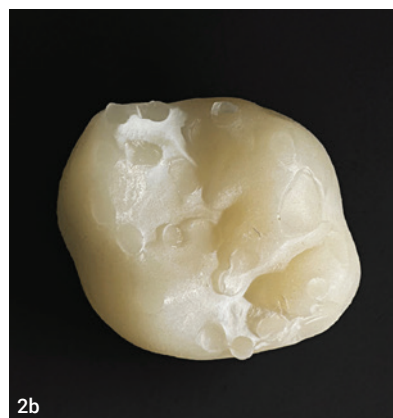
Abb. 2: Kronen nach dem Fräsen (2a) bzw. Drucken (2b). Beim Fräsen bleibt ein Haltesteg stehen, der hier seitlich am Werkstück platziert ist und sich leicht von Hand entfernen lässt. Die Stützstruktur des 3D-Drucks bestand aus mehreren dünneren Stegen, die sich auch direkt auf der Kaufläche befanden. Bei ihrer Entfernung können die feinen Details einer modellierten Kaufläche wieder verloren gehen. Reste des Druckharzes sind noch als weiße Schicht erkennbar.
