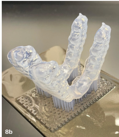
Abb. 8a+b: 3D-gedruckte Schienen mit Stützstrukturen auf Bauplattform.
