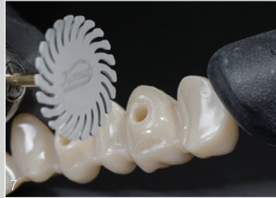
Abb. 4–7: Werkstoffgerechte Bearbeitung von Zirkonoxid im Überblick: Restauration im Weißlingszustand; Ausarbeiten mit Hartmetallfräsern; Zirkonoxidstaub mit weichem Pinsel (KEINEM Dampfstrahler!) entfernen; die Bearbeitung der gesinterten Brücke mit einem diamantierten Schleifkörper (DCB-Schleifer); Finishing mit einem ETNA-Polierer für die Hochglanzpolitur.
