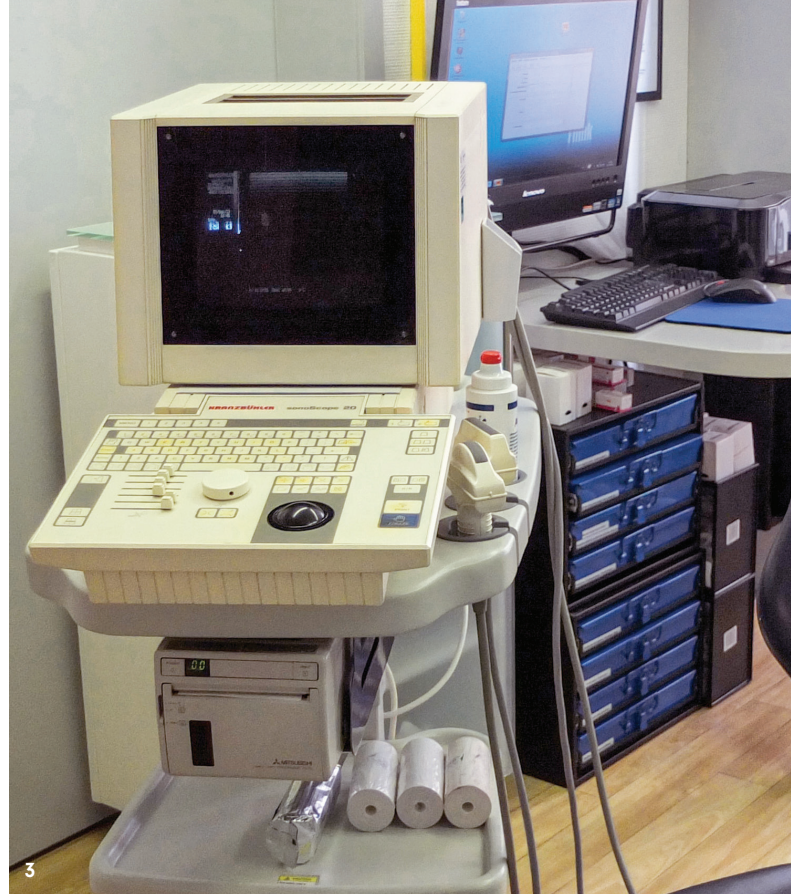
Abb. 3: Portables B-Scan-Gerät (Kranzbühler), das Gerät kann aufgrund seines geringen Gewichtes (7,5 kg) und der für ein B-Scan-Gerät geringen Ausmaße von Behandlungszimmer zu Behandlungszimmer mitgenommen werden.
