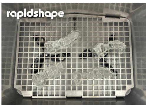
Abb. 8: Postprocessing – in der Rapid Shape WASH erfolgt die Spülung mittels Isopropylalkohol.
