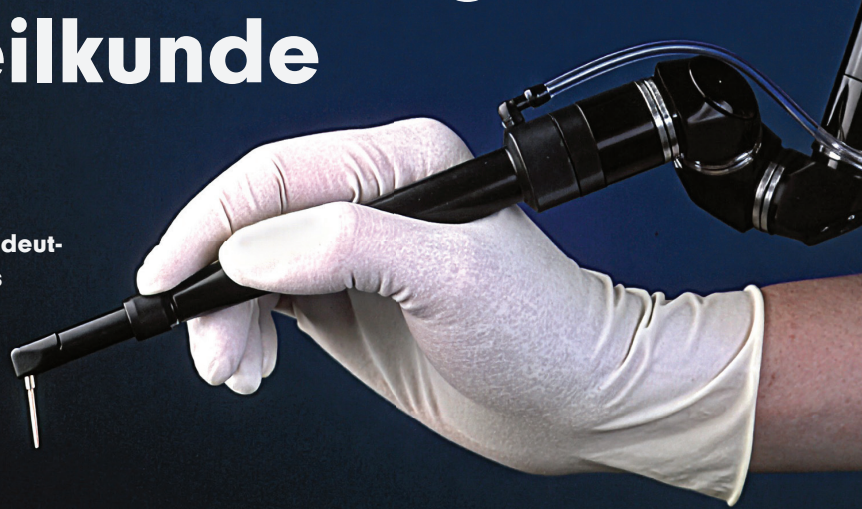
Abb. 1: CO 2 -Laserlicht wird i. d. R. über einen Spiegelgelenkarm übertragen.
