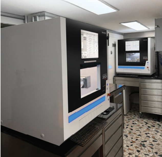
Abb. 1: Unsere je 0,2 Tonnen schwere CORiTEC 350i PRO-Fräsanlagen mit einem Platzbedarf von je 0,6 Quadratmetern.
