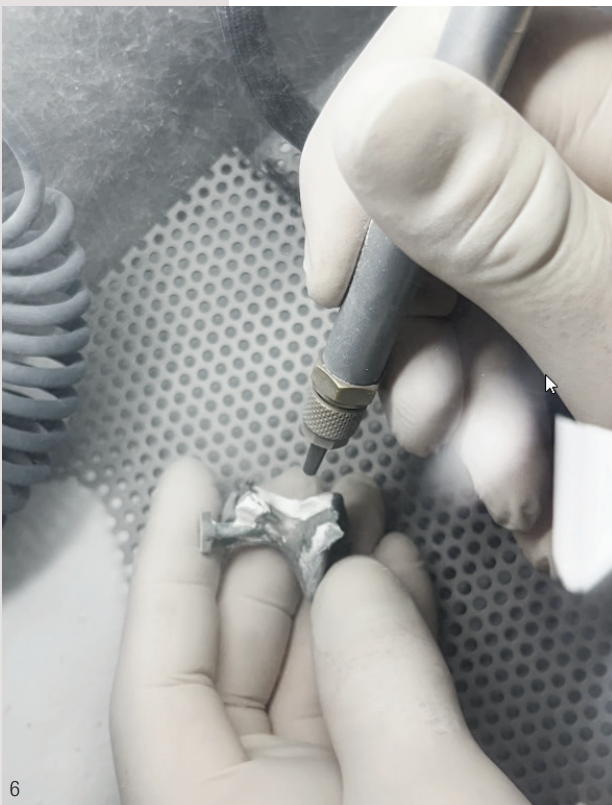
Abb. 5: Oxidschicht auf einem Modellteil vor dem Sandstrahlen. – Abb. 6: Sandstrahlprozess eines Modellteils. Alle Abbildungen: © Dentallabor Rehra GmbH
