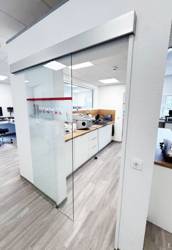
Abb. 1: Der integrierte Geräte-Kubus mit automatischen Schiebetüren schirmt die lauten Geräte vom Rest der Etage ab.
