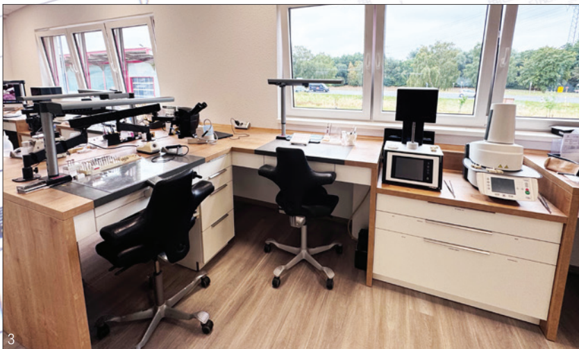
Abb. 3: Der L-förmige Arbeitstisch mit Ausarbeitungs-/Keramikschicht-Platz und abgesenkten Schränken für die Sinteröfen.
