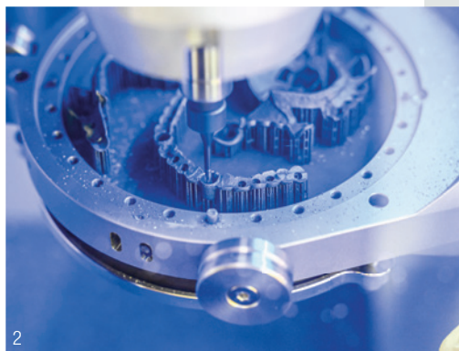
Abb. 1: Einblick in das Dentallabor mit den Maschinen von imes-icore. – Abb. 2: Fräsnachbearbeitung der 3D-gedruckten Teile. – Abb. 3: Finale Indikation gefertigt mit der Hybridtechnik.
