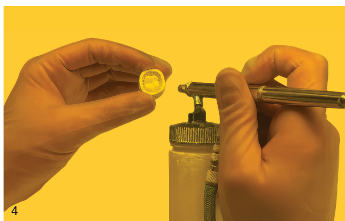
Abb. 3: Abgebildet sind der individuell an die Krone angepasste Supportring und separat davon die zuvor darin stabilisierte Krone. Die Krone wird nach dem Entbindern vom Supportring befreit. Er stabilisiert die Krone während des Druckvorgangs und fängt formgefährdende Kräfte bei Reinigung und Entbinderung ab. – Abb. 4: Manuelle Reinigung (Airbrushing) der gedruckten Kronen zur Entfernung überschüssiger Suspension mittels aufgesprühtem Isopropanol unter kontrolliertem Druck.
