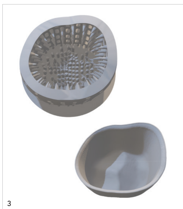
Abb. 3: Abgebildet sind der individuell an die Krone angepasste Supportring und separat davon die zuvor darin stabilisierte Krone. Die Krone wird nach dem Entbindern vom Supportring befreit. Er stabilisiert die Krone während des Druckvorgangs und fängt formgefährdende Kräfte bei Reinigung und Entbinderung ab. – Abb. 4: Manuelle Reinigung (Airbrushing) der gedruckten Kronen zur Entfernung überschüssiger Suspension mittels aufgesprühtem Isopropanol unter kontrolliertem Druck.
