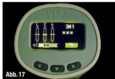
▲ Abb. 17: Die gemessenen Helligkeits-, Farbintensitäts- und Farbtonwerte befinden sich innerhalb der Grenzen einer sehr genau getroffenen Farbe 3M1; die drei Sterne auf dem Display bedeuten zudem, dass die Farbe präzise übereinstimmt. ▲ Abb. 18: Die Herstellungsschritte vom Gerüst bis zur fertigen Krone. Die VMK Master Keramik ermöglicht es, Kronen mit einer sehr dünnen Schichtstärke herzustellen.
