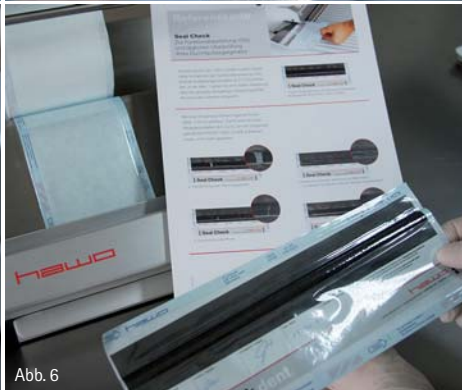
Abb. 4a-b: Scharfkantige Instrumente oder spitzes Füllgut müssen separat gesichert werden. – Abb. 5: Bei Öffnen der Verpackung muss diese immer „aufgepeelt“ werden. Instrumente dürfen niemals durch die Verpackung gebrochen werden. – Abb. 6: Tägliche Überprüfung der Siegelgeräte mittels Siegelindikator.
