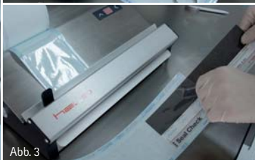
Abb. 1: Das neue ValiPak® von hawo (hd 380 WSI-V) ist ein voll validierbares Balkensiegelgerät. – Abb. 2: Das Durchlaufsigelgerät hd 680 DEI-V von hawo ist validierbar und mit Schnittstellen zur Datenübertragung ausgestattet. – Abb. 3: Die geforderten „Qualitätseigenschaften“ können während der Validierung mittels SEAL CHECK Siegelindikator überprüft werden.
