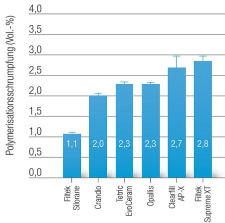
Abb. 4: Polymerisationsschrumpfung, gemessen nach dem Archimedes'schen Auftriebsprinzip.\*
