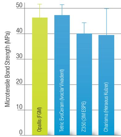
Abb. 5: Mikrozugversuch zwischen Dentin und unterschiedlichen Kompositen mit dem Bonding Ambar (FGM).\*\*
