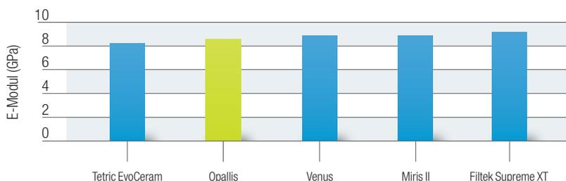
Abb. 2: E-Modul unterschiedlicher Komposite.\*
