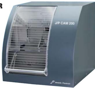
Position auszuwählen. Die jeweiligen Fräseparameter werden automatisch erstellt. Anschließend werden die dreidimensionalen CAD-Daten im STL-Format importiert und für die Ausgabe aufbereitet. Vorkenntnisse im Fräsen sind laut Hersteller nicht nötig. Auch filigrane Wachsmodele könnten auf diese Weise angefertigt werden.
