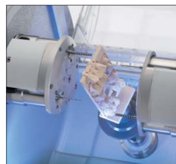
Modelle fräsen mit der inLab MC XL.
