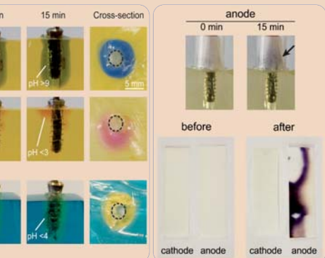
Elektrochemische Implantatbehandlung. Fotografische Dokumentation bei der Verwendung von pH-sensitiven Farben zur Visualisierung für Thymolblau: pH über 9 (alkalisch), Pink: pH unter 3 (sauer), Grün: pH unter 4 (stark sauer). – Grafik 2: Produktion von oxidativen Spezies in vitro und nach der Behandlung der Implantate in simuliertem Mundmilieu nach der Elektrolyse.
