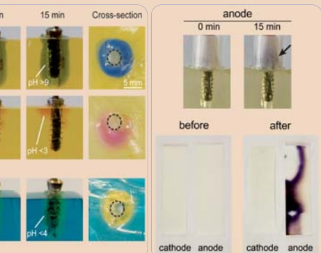
Elektrochemische Implantatbehandlung. Fotografische Dokumentation bei der Verwendung von pH-sensitiven Farben zur Visualisierung für Thymolblau: pH über 9 (alkalisch), Pink: pH unter 3 (sauer), Bromkresolgrün (Bromkresolgrün) erlaubte die Abbildung eines Weichgewebes, das sich ein homogener und kreisförmiger Weichgewebe entwickelte. – Grafik 2: Produktion von oxidativen Spezies in vitro und nach der Behandlung der Implantate in simuliertem Mundmilieu nach der Elektrolyse.
