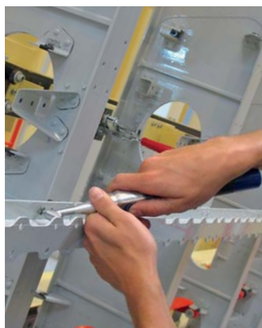
Der akkubetriebene AL-1 90° im Einsatz bei Airbus.
