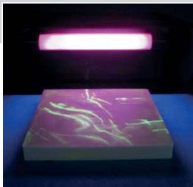
auf Rissbildung bzw. Chipping. Der mobile Aluminium Prüfkoffer beinhaltet eine ZR-UV-Prüflampe, einen Behälter mit wasserlöslicher fluoreszierender Prüfflüssigkeit, eine Brille, Handschuhe und zwei Objektzangen für jeweils Gerüst oder Blank. Einschlüsse und Mikrorisse werden sofort erkannt und sind somit im laufenden Herstellungsprozess von Zirkon-Zahnersatz ausgeschlossen.
