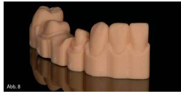
Abb. 1–4: Alles wird in einem Prozess gefertigt. – Abb. 5: Baukastensystem mit Metall-Pin. – Abb. 6–7: Die Objekte direkt nach der Fertigung und Reinigung. – Abb. 8: Die zu erreichende Präzision liegt unter 30 µ.
