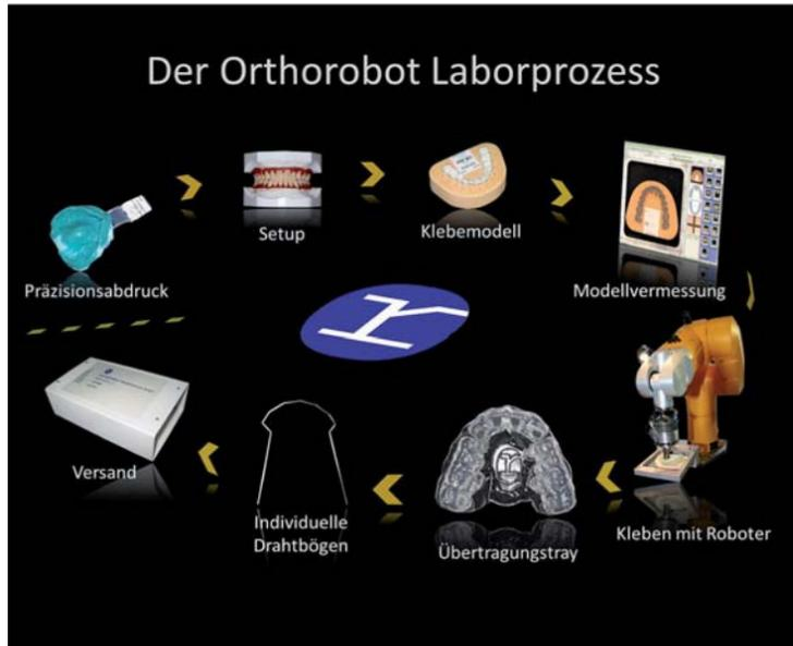
Abb. 3: Übersichtsdiagramm Orthorobot-Laborprozess.
