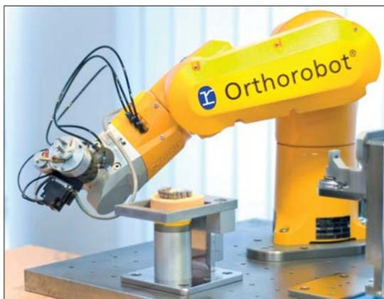
Abb. 5: Kleberoboter „in Aktion“.
