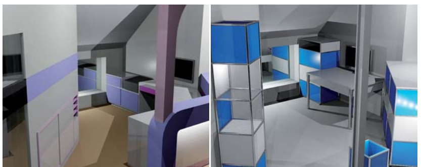
Abb. 4: Der Monitor ist an einem flexiblen Arm befestigt und kann geschwenkt werden. Die Tischfläche hat sich verdoppelt. Die Trockenbauwand lässt sich ohne großen Aufwand öffnen. So entstand ein Korpusmöbel, welches viel Stauraum bietet. Hinter dem Korpus entstand ein Sideboard zur Büroseite. – Abb. 5: Unter dem Drempele der Dachschrägen sieht man die einzige Lichtquelle für diesen Raum. Der Arzt wünschte sich den Monitor an der Wand montiert, um Einblicke wie beim alten Empfang zu vermeiden. Auf Funktionalität wurde dieser nicht besonders gut beraten.
