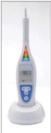
der elektrischen Leitfähigkeit des Zahns einher. Mittels AC-Impedanzspektroskopie misst CarieScan PRO™ präzise die Veränderungen der Zahndichte. In der Karies-Früherkennung ist mit der ACIST-Technologie eine direkte Messung der Kariesausprägung möglich, auch bei kleinen kariösen Läsionen und versteckter Karies. Die Messergebnisse werden nicht durch Ablagerungen auf den Zähnen oder durch visuelle Mängel beeinflusst. CarieScan PRO™ ist ein
