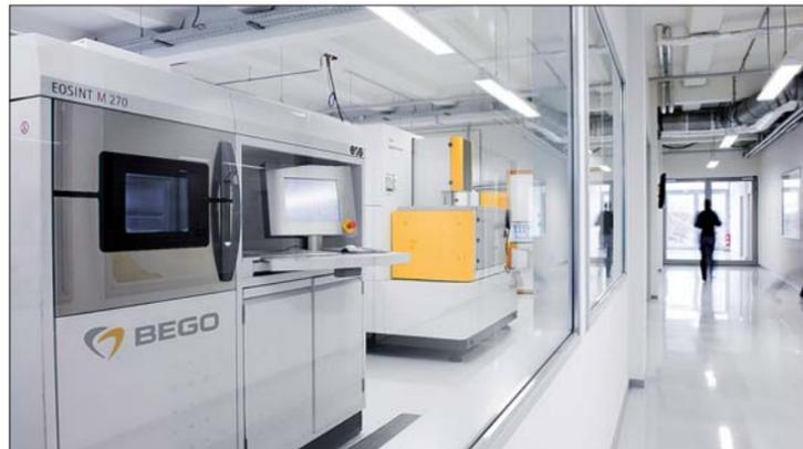
In der neuen „Gläsernen Fabrik“ am Stammsitz Bremen fertigt BEGO auf Grundlage von CAD-Modellierungen Gerüste mit modernster Laser- und Frästechnik in derzeit vier verschiedenen Verfahren.
