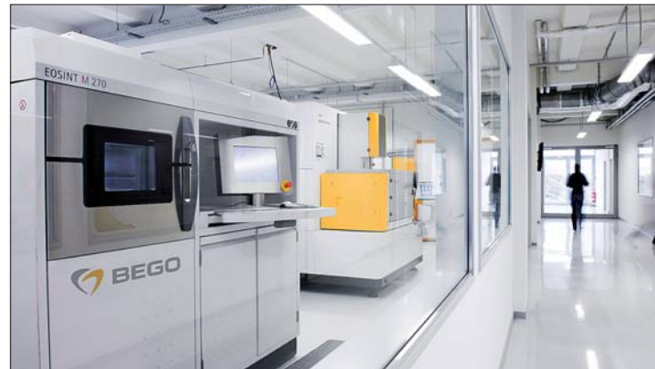
In der neuen „Gläsernen Fabrik“ am Stammsitz Bremen fertigt BEGO auf Grundlage von CAD-Modellierungen Gerüste mit modernster Laser- und Frästechnik in derzeit vier verschiedenen Verfahren.
