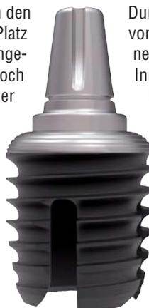
Durchmesser von 4,5 und einer Länge von 12 mm. Das GIP-Implantat hat einen Durchmesser von 7 mm, mit dem Innendurchmesser von ca. 5 mm und Längen von 4 bis 7 mm. Die 2 mm unter der Implantatschulter ansetzenden vier Längsfräsungen bewirken eine stabile knöcherne Verbindung zum breiten inneren Knochenzylinder und garantieren die Rotationsstabilität des Implantates. Zudem ist durch das Mikrorillendesign der breiten Schulter ein Platform Switching-Effekt gewährleistet.
